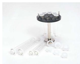
下記の部品は消耗時の交換や、付属のものとは異なる径の試験管を使用する場合にのみ必要です。
