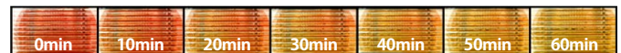
図4. AGVによる色変化 (映像のキャプチャー画像、彩度調整済)
