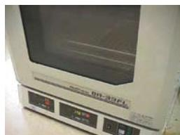
図2. BR-33FLによる*Shewanella* sp. Ac10の振とう培養の様子。容器は試験管、設定温度は4°C、振とう速度は往復で170r/minでした。
